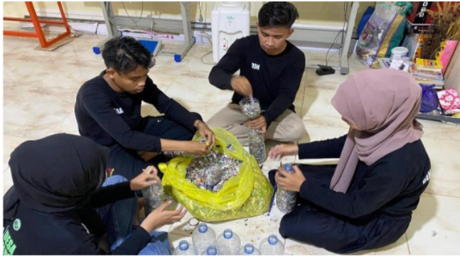
Gambar 6. Proses Memasukkan Cacahan Plastik Kedalam Botol
