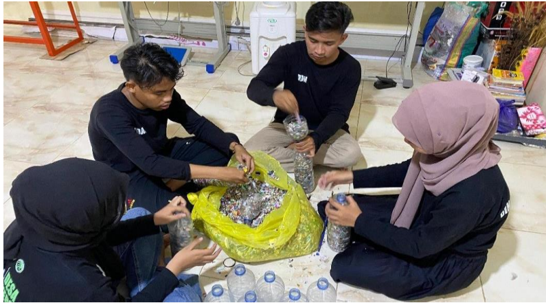
Gambar 6. Proses Memasukkan Cacahan Plastik Kedalam Botol
