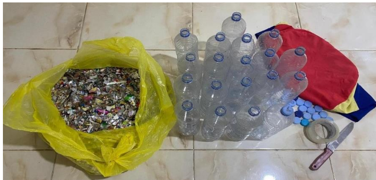
Gambar 5. Alat dan Bahan Pembuatan Kursi dari Ecobrick
